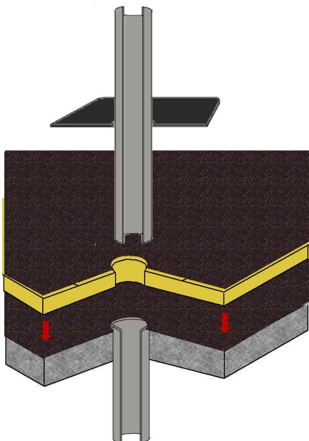
2. Bringen Sie die erste Abdichtungslage auf und stecken den Sanitälüfter in das Unterteil. Hier empfehlen wir die Verbindung mit Quellschweißmittel zu sichern. Verschweißen Sie die Unterseite des Sanitälüfters mit der ersten Abdichtungslage.
