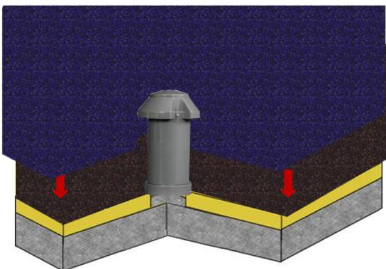
2. Bereiten Sie die Dachbahn/Oberlage vor und verschweißen Sie diese auf die vorhandene Anschlussbahn des Ablaufs. Grundsätzlich ist der werksmäßige Flansch nicht als Oberlage zu verwenden.
